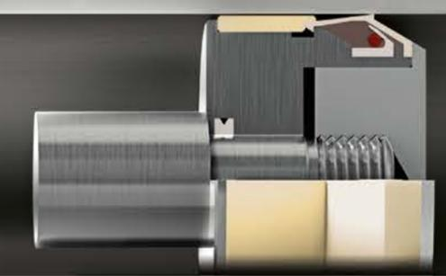
Corpo pistone assemblato mod. **"Compact"** con fascia di guida non tagliata e tenuta in materiale **PTFE PEEK**. In posizione extracorsa per lavaggio e/o sanificazione.
